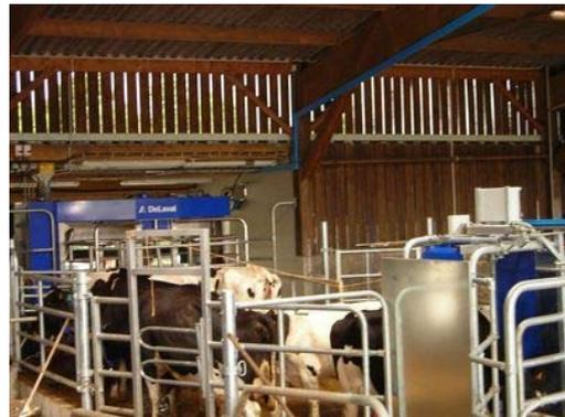
Foto 1: Melkroboter mit Selektionstor
