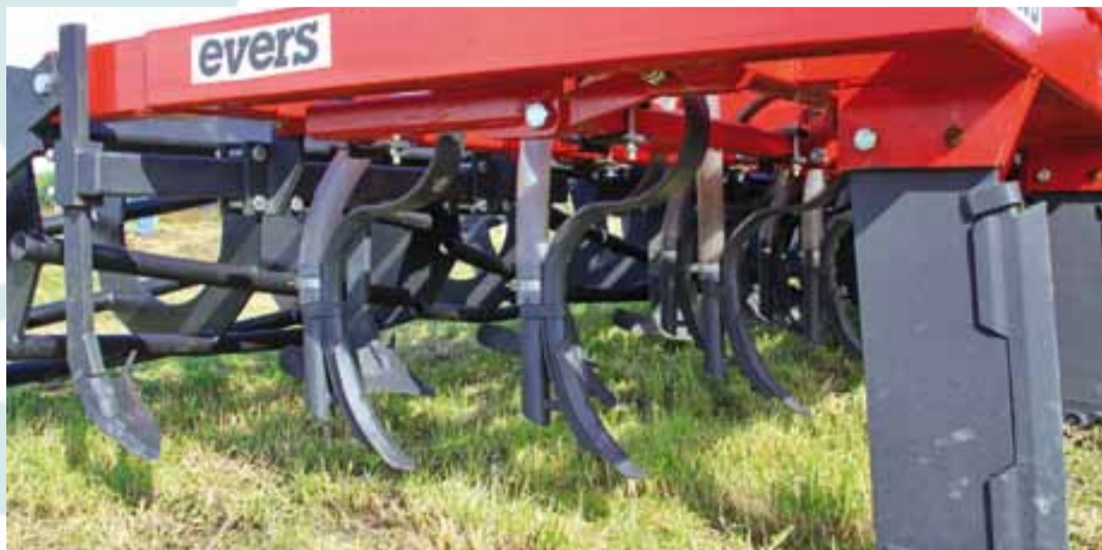
Drijfmestinjecteur met GPS-registratie, zodat de maïs daarna bij de mest gezaaid wordt.
