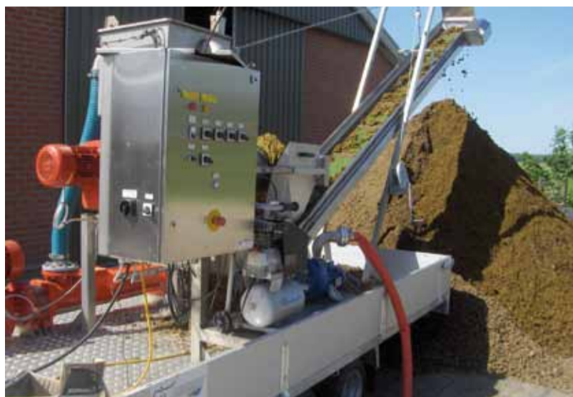
De mobiele schroefpersfilter van Smicon produceert een mooie, droge, dikke fractie op het bedrijf van Post in Nieuweroord (Dr).
