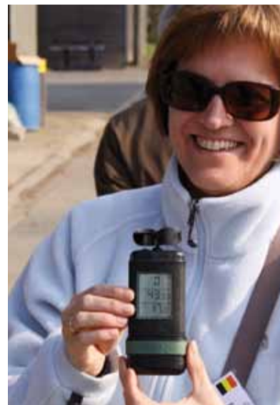
Ilse van den Broeck van KTC Hooibeekehoeve (België) toont het mobiele weerstation dat KTC Derval gebruikt bij de gewasbescherming. Het toont achtereenvolgens windsnelheid, luchtvochtigheid en temperatuur.
